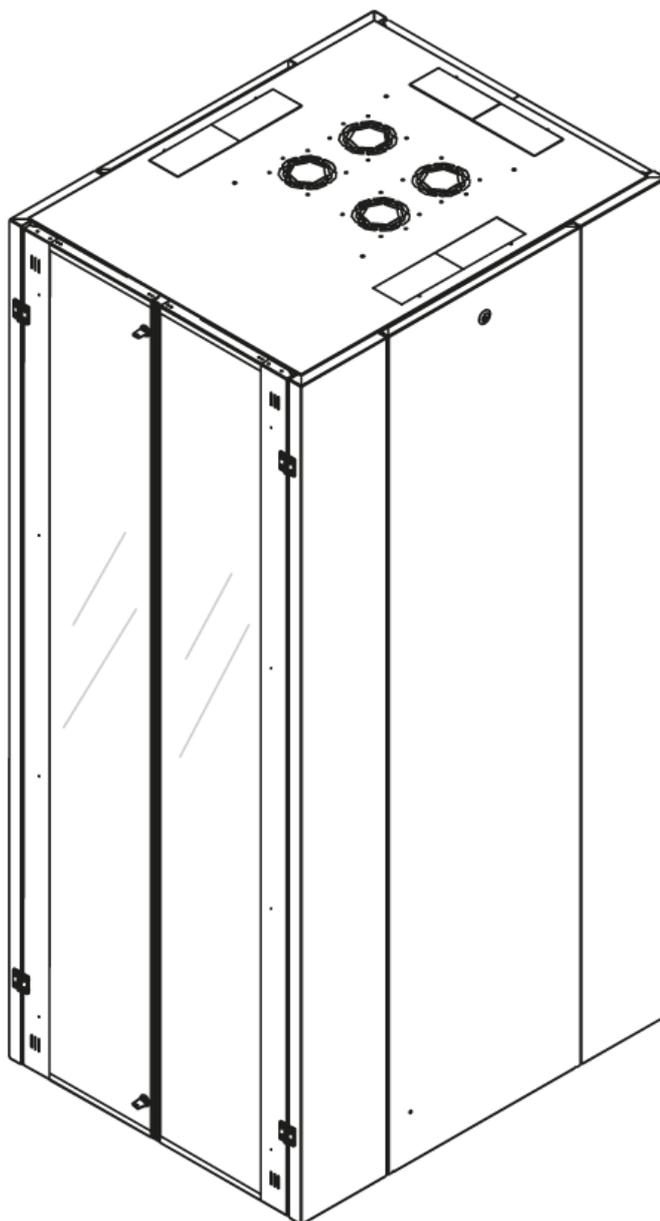
Распределенная нагрузка: до 600 кг на роликах, базовая 900 кг на опорных ножках.
